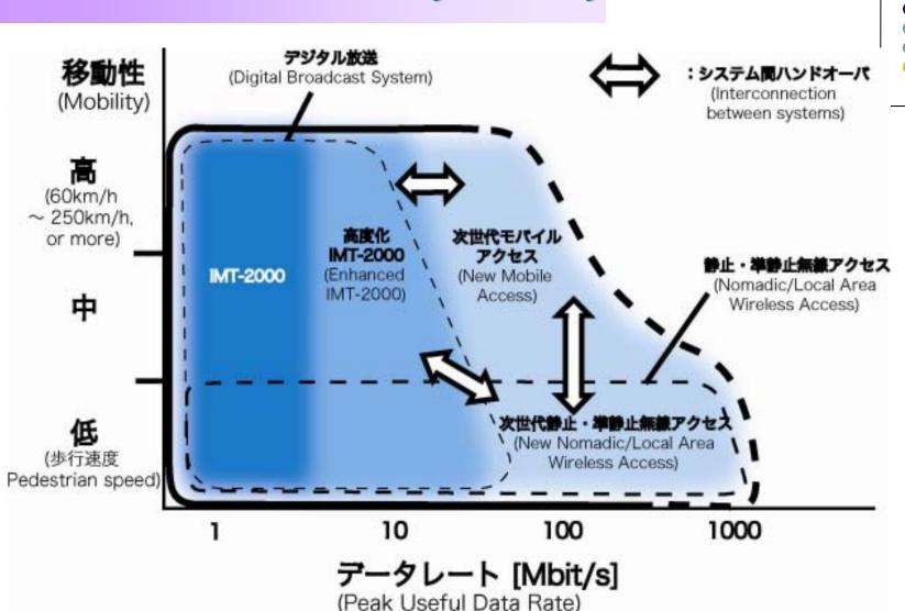
濃い青が現在のIMT-2000、中間の青が高度化IMT-2000、薄い青がIMT-2000の次の世代のシステム
